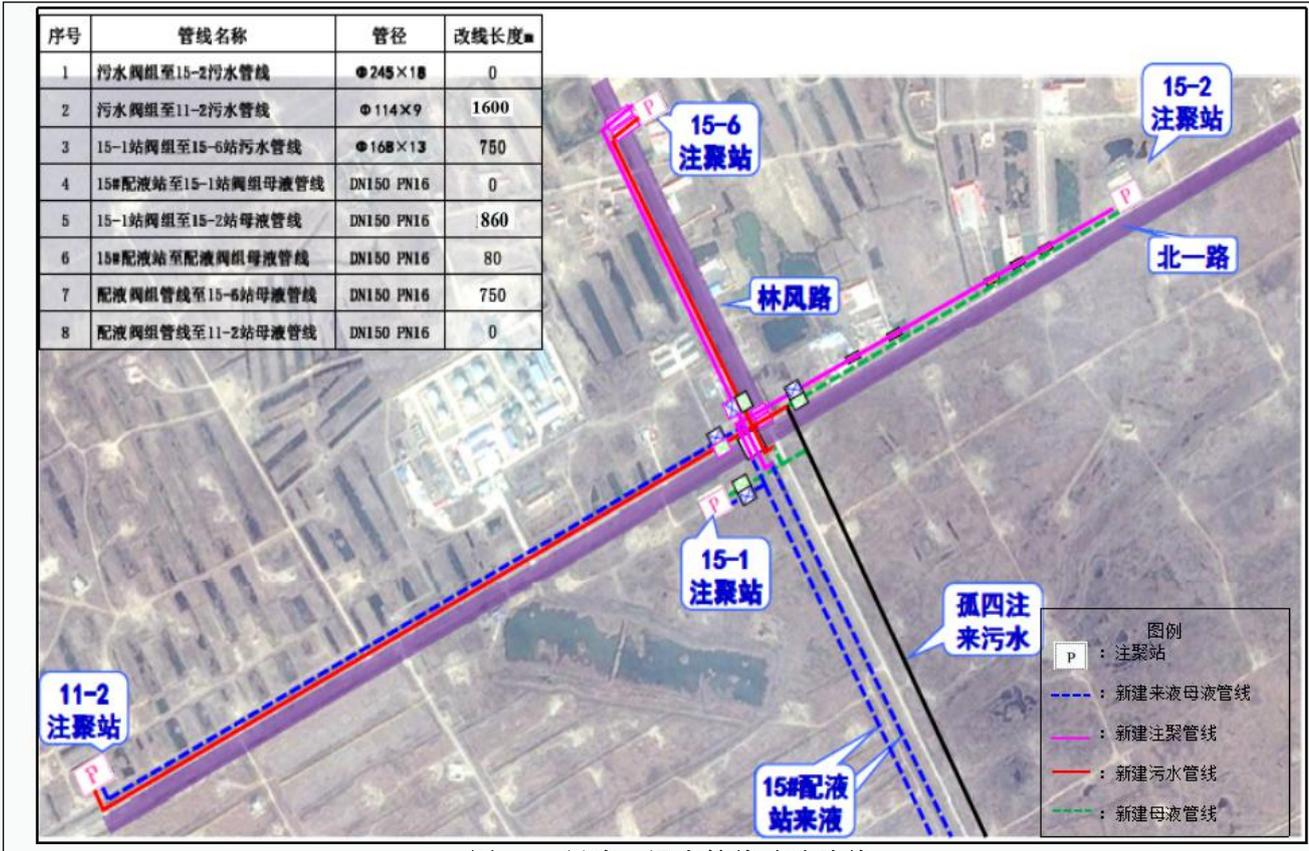
图 2-19 母液、污水管线改造路线
