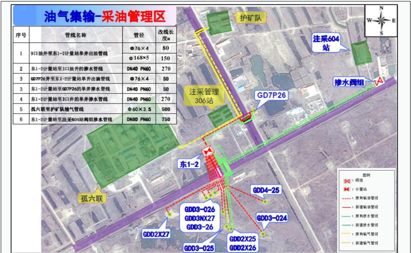
图 2-15 集输管线改造路线二
