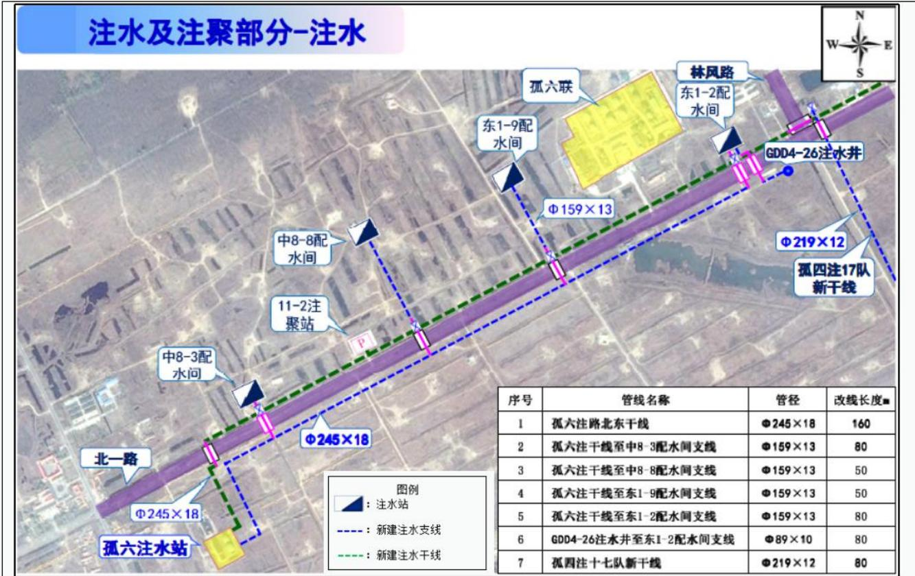
图 2-17 注水管线改造路线
