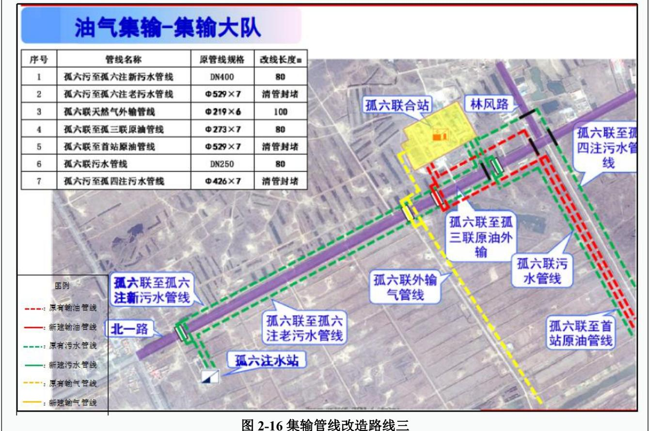
图 2-16 集输管线改造路线三
