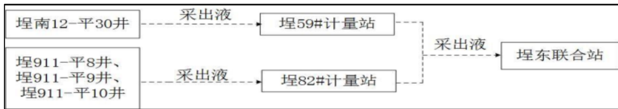
图 2-4 油井集输系统流程图
