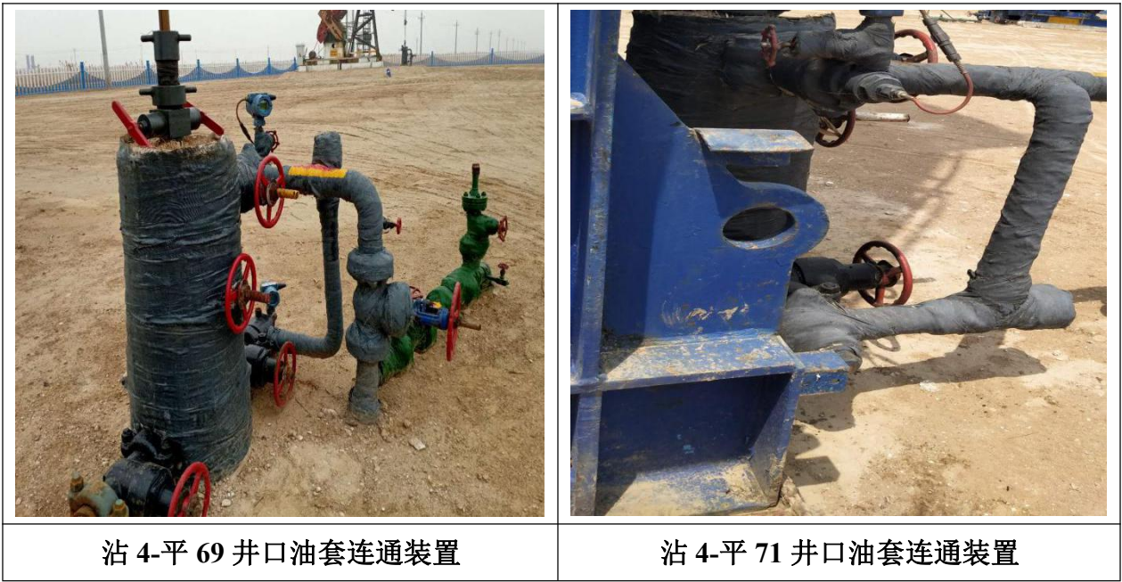
图 4-2 井口套管气回收装置图
