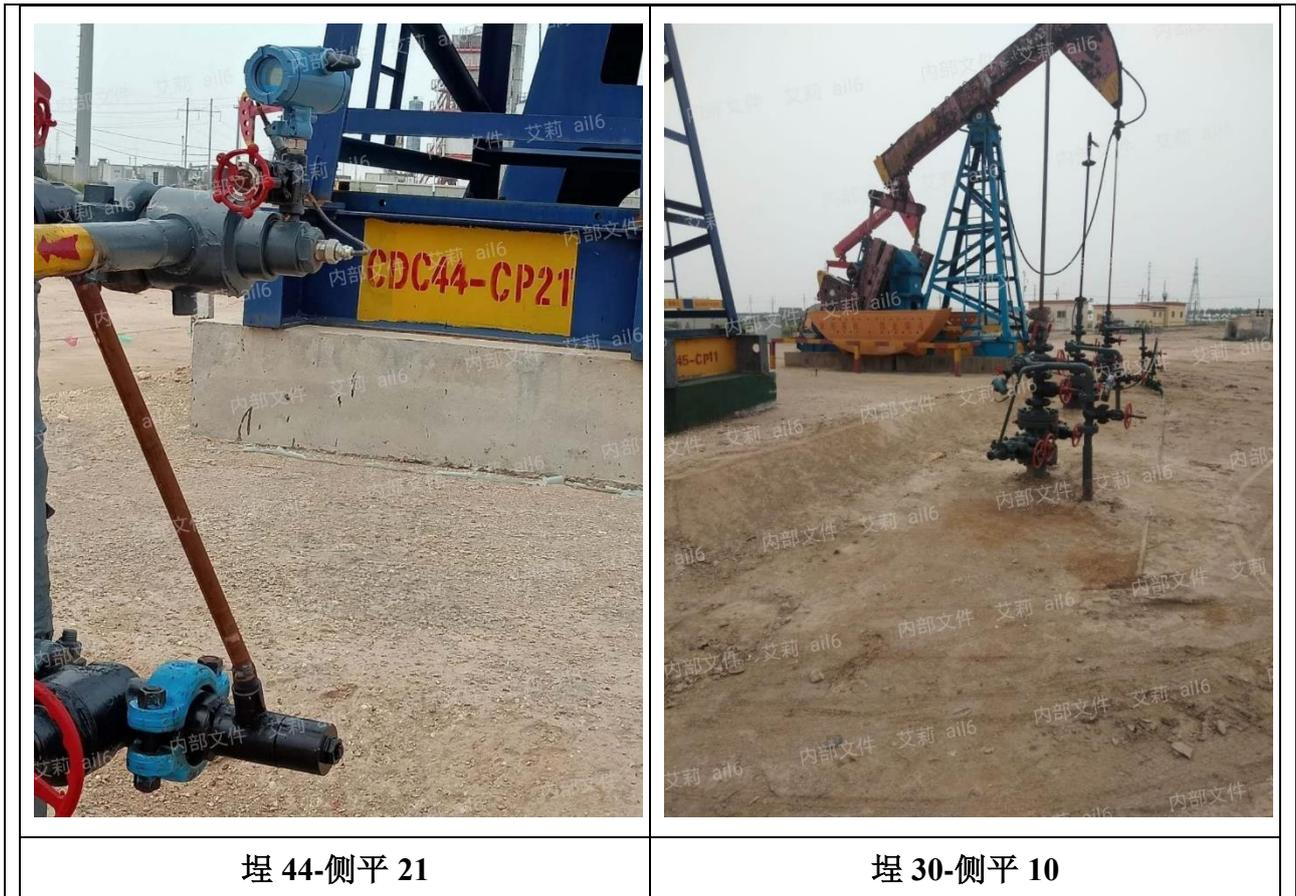
**图 4-2 井口套管气回收装置图**
