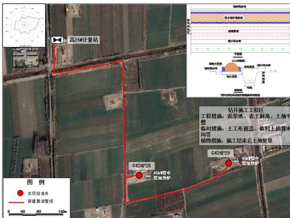
图 5-1 施工期生态保护措施示意图 (以高 424-平 27 块两口油井为例)
