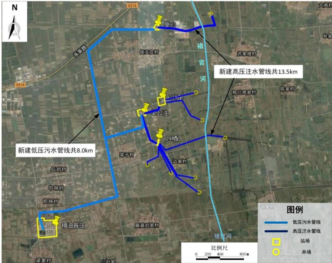
图 2-1 单 12 注水站、单 83 注水站及新建站外管线图
