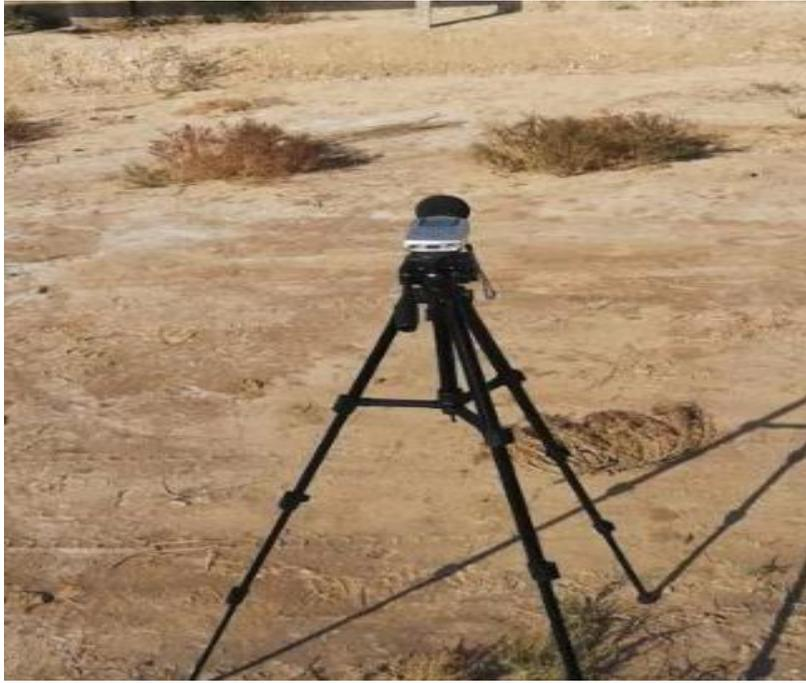
图 5-3 厂界噪声监测现场照片
