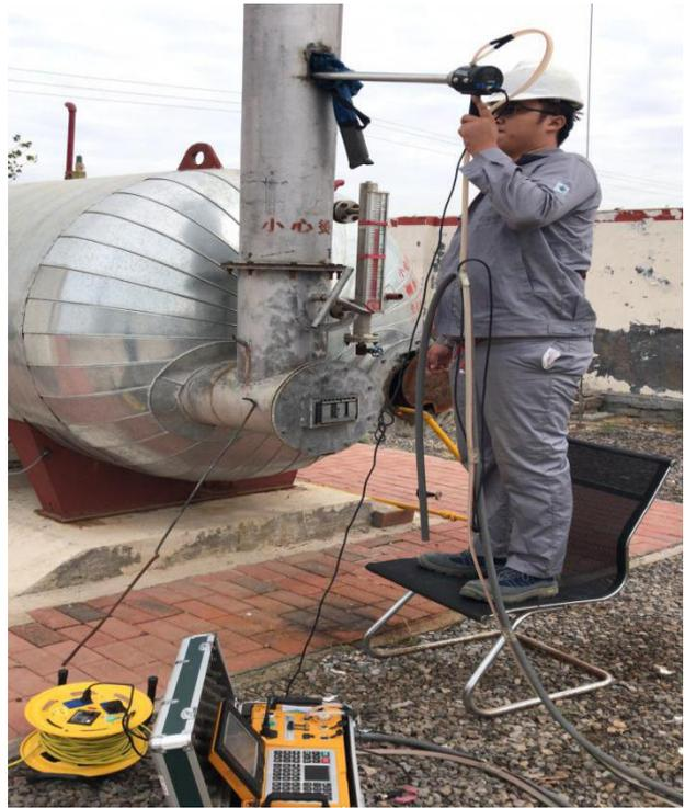
图 5-2 非甲烷总烃及水套加热炉废气监测现场照片
