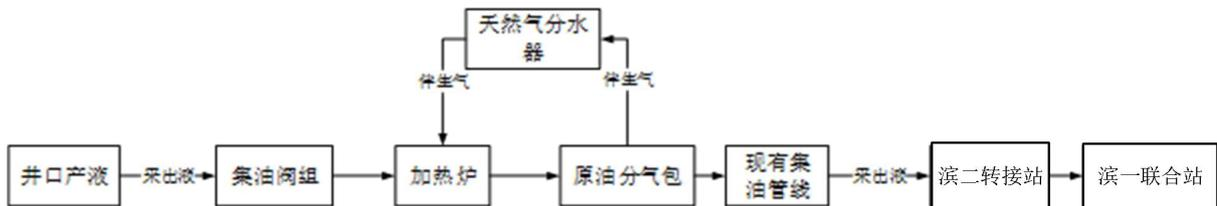
图 3-2 集输流程图
