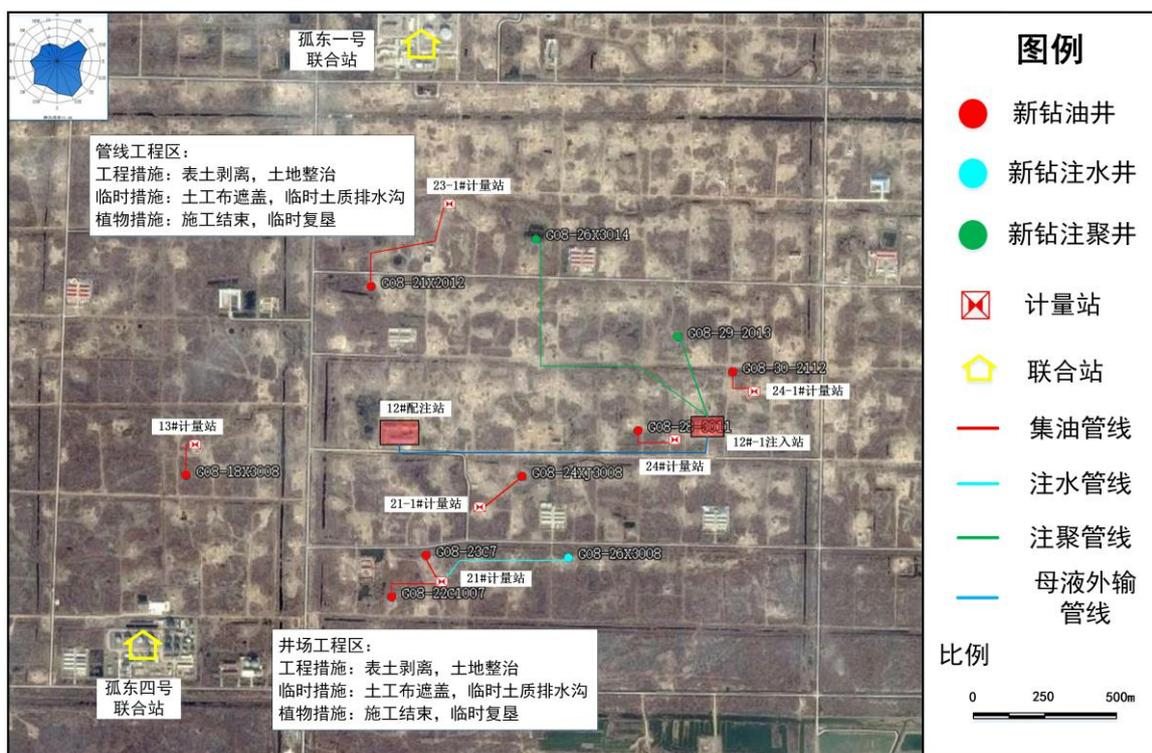
图 5-1 施工期生态保护工程示意图
