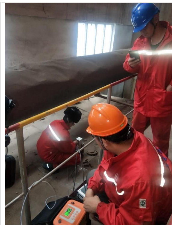
除尘设施进口监测
